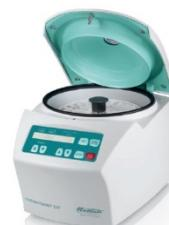
Appareil de rotation rapide utilisé pour centrifuger des tubes capillaires à hématocrite.
